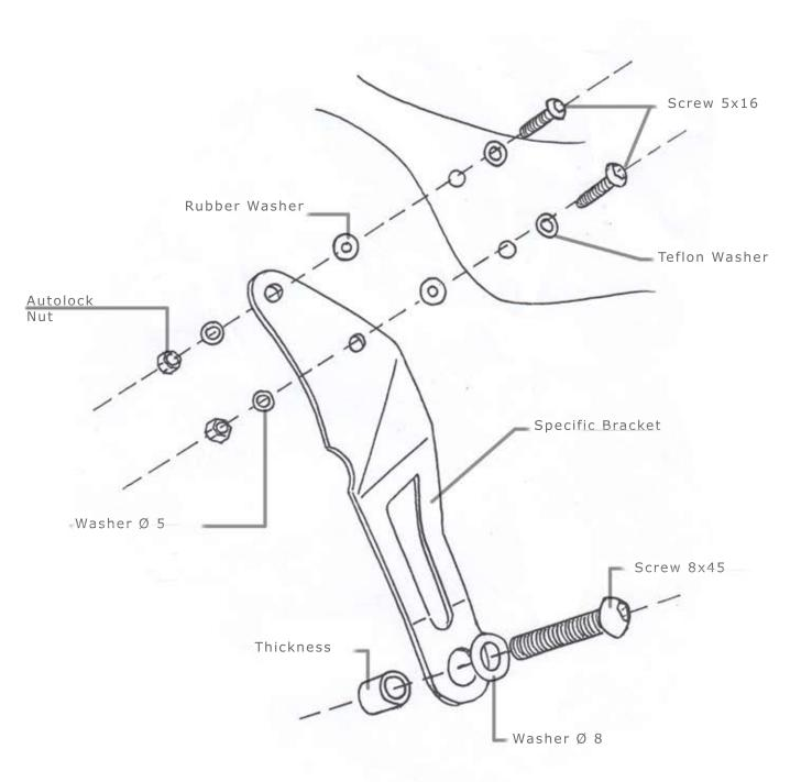
INSTALL THE WINDSHIELD/SCREEN LIKE DESCRIBED IN THE PICTURE: PUT THE TEFLON WASHERS BE-TWEEN THE HEAD OF SCREWS AND THE WINDSHILED/SCREEN. DON'T LOCK TOO MUCH THE AUTOLOCK NUTS TO AVOID THE PLEXIGLASS DAMAGES.
